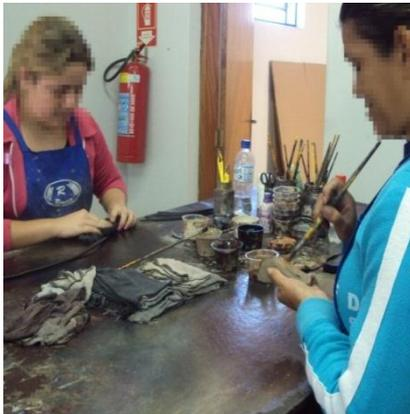
Figura 7 – Funcionárias da colagem e pintura sem utilização de EPIs. Fonte: Fábrica “X”
