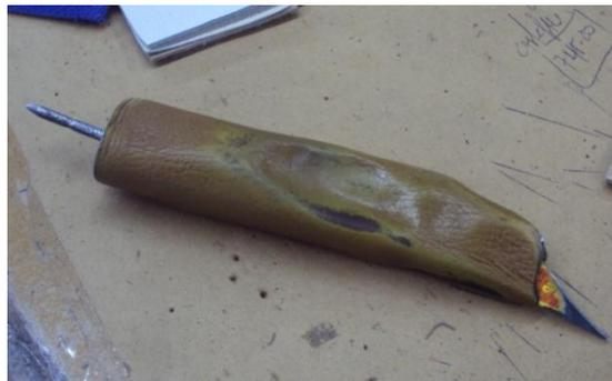
Figura 5 – Ferramenta utilizada no corte de couro. Fonte: Fábrica “X”
