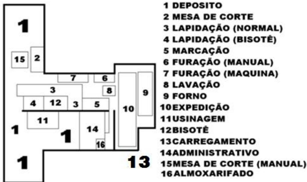
Figura 4 – Disposição de máquinas, equipamentos e setores. Fonte: arquivo Tempermed.
