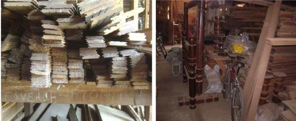
Figuras 3 e 4 – Estocagem no armazém: não há identificação no local de armazenagem, e há mistura de produtos armazenados em um mesmo local
