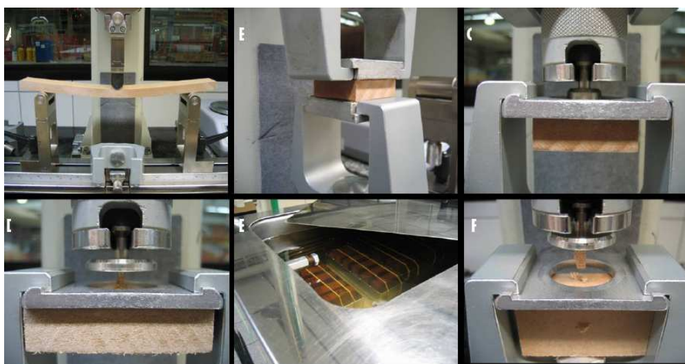
Figura 6 – Avaliações físico-mecânicas do painel de MDF*
