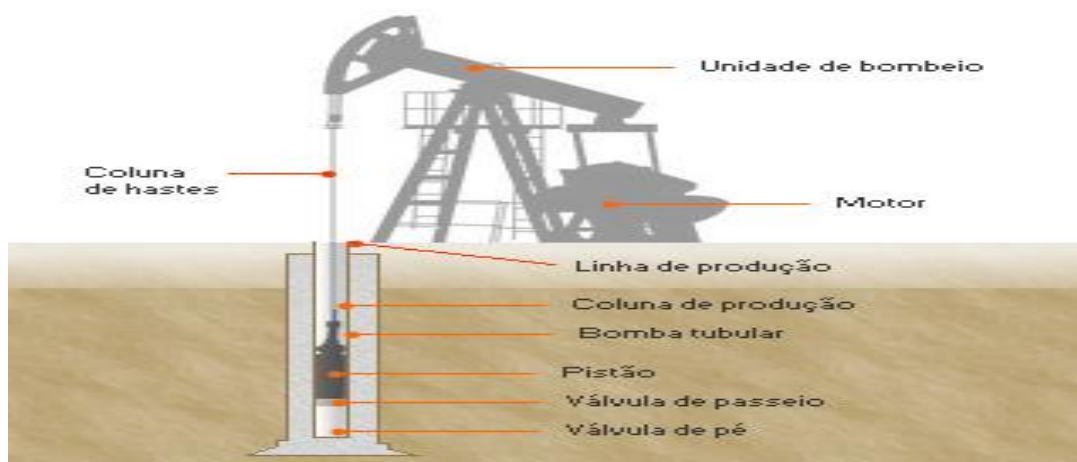
Anexo II- Unidade de Bombeio Mecânico – “cavalo de pau” Fonte: galp energia(2013)
