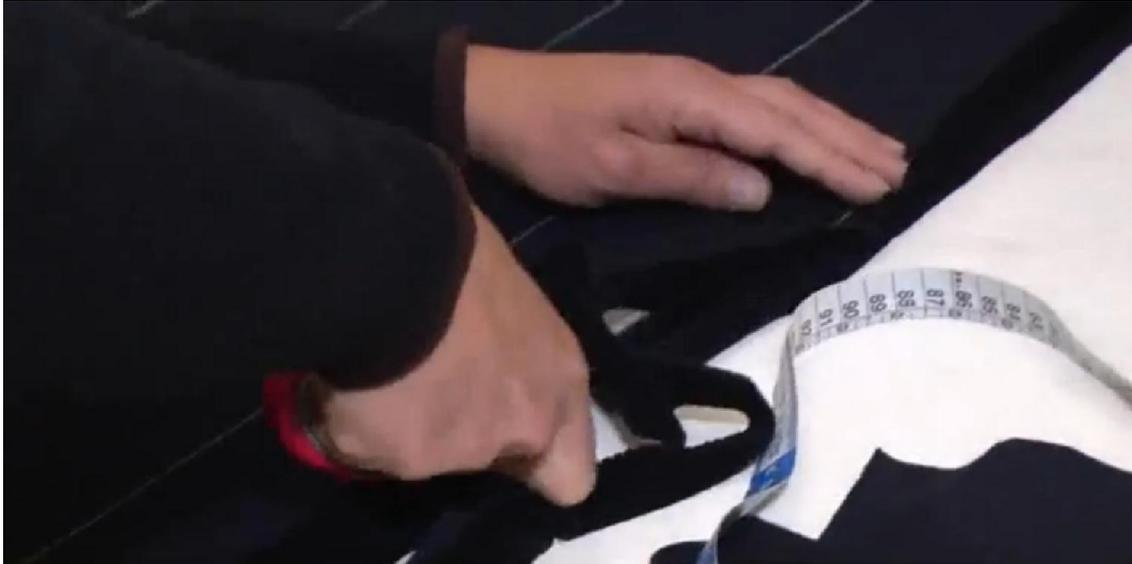
Figura 3: Ilustração de riscos no tecido e o corte sendo realizado com tesoura
