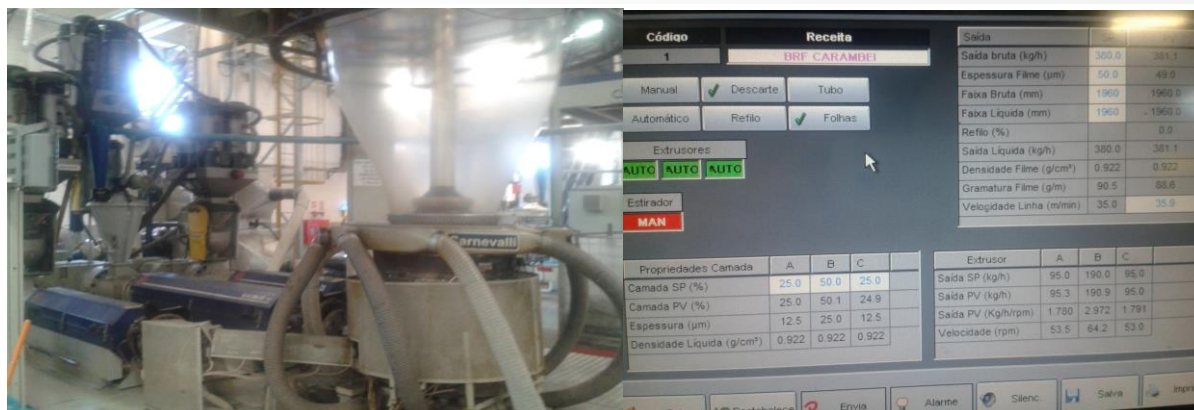
Figura 2: Coextrusora do setor de extrusão e IHM de programação da Indústria de Plásticos A. Fonte: Indústria de Plásticos A.
