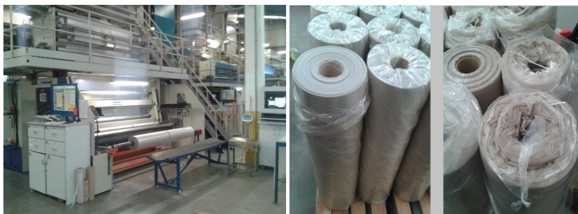
Figura 3: Bobinas de filme plástico da extrusora simples no setor de extrusão e a diferença entre bobinas alinhadas e bobinas desalinhadas. Fonte: Indústria de Plásticos X.
