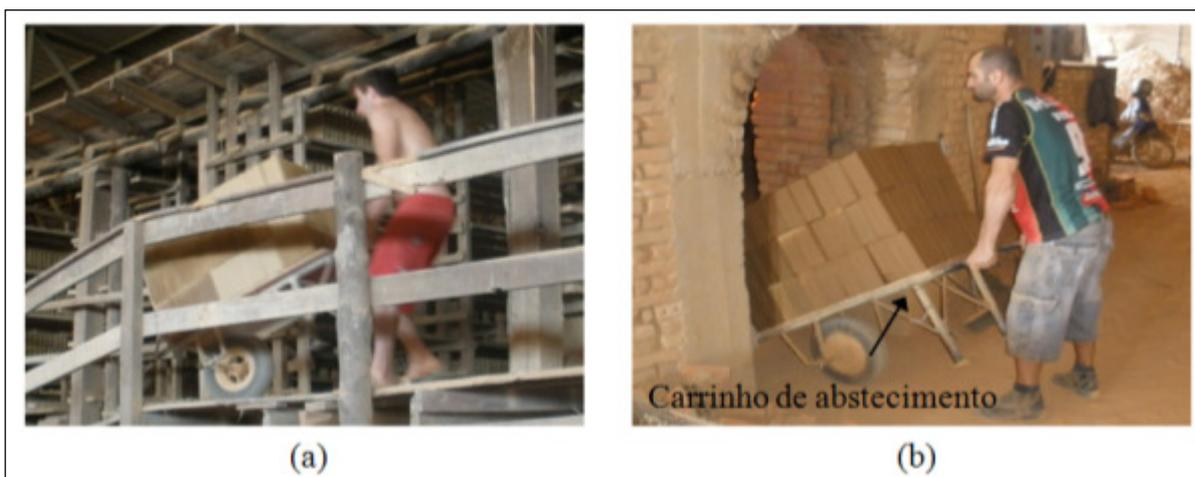
Figura 4 - Sistema de abastecimento dos fornos de queima, (a) retirada dos estoques; (b) entrada do forno
