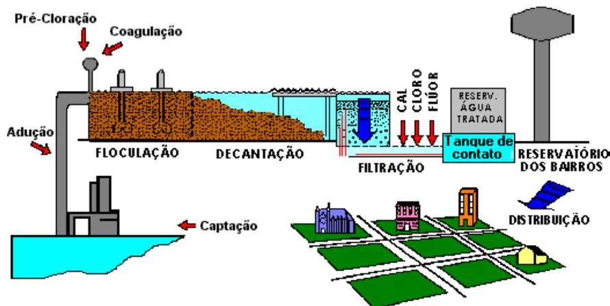
Figura 1 – Processo convencional de tratamento de água (Fonte: SAAE, 2006)
