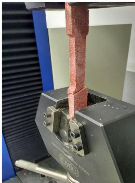
Figura 3 – Falha em amostra durante ensaio de tração
