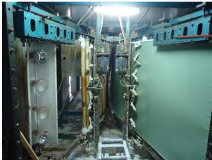
Figura 3 – Perfiladeira para fabricação de painéis térmicos. Fonte: Os autores (2016).
