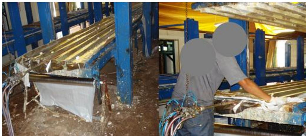
Figura 2 – Fabricação de telha com injeção de poliuretano. Fonte: Os autores (2016).
