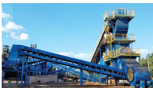
**Figura 3:** Ilustração dos equipamentos para limpeza a seco (Fonte: DEDINI, 2015).
