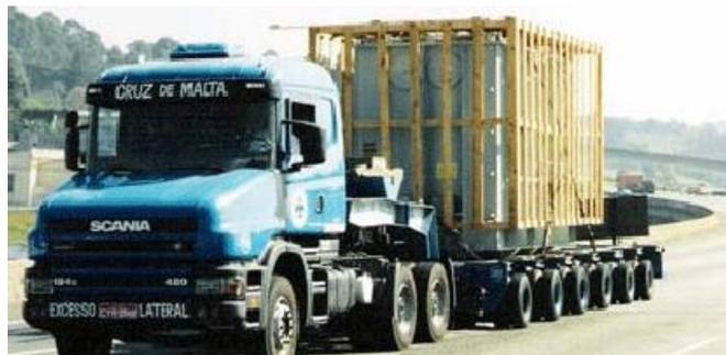
Figura 2 – Carga Indivisível Transformador. Fonte: Guia do TRC
