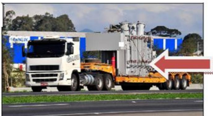
Figura 4 Amarração de transformador. Fonte: Gislon Transportes Ltda.
