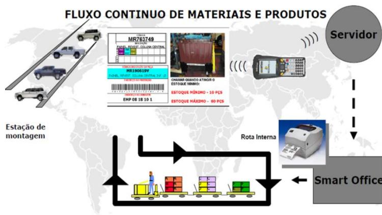
Figura 2: Processo da movimentação de materiais
