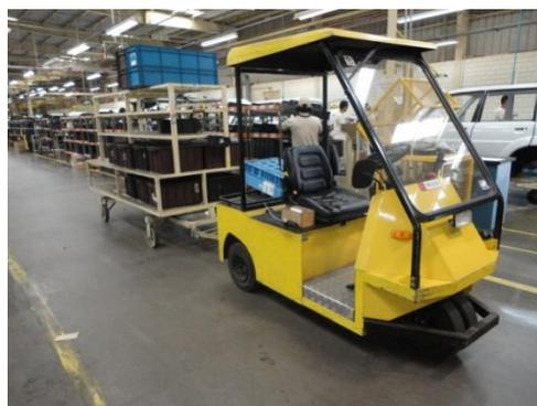
Figura 4: Transportador interno de peças
