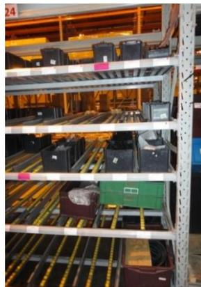
Figura 1: Peças armazenadas em estante (*flow-rack*)
