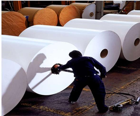
Figura 2 – Bobinas de Celulose Branqueadas
