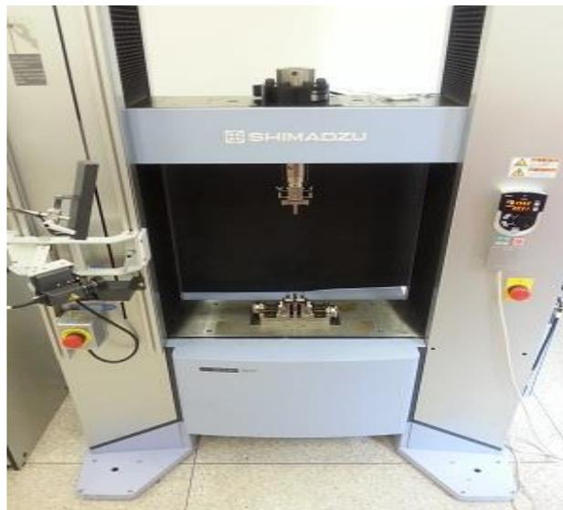
Figura 5 – Máquina utilizada nos ensaios de tração
