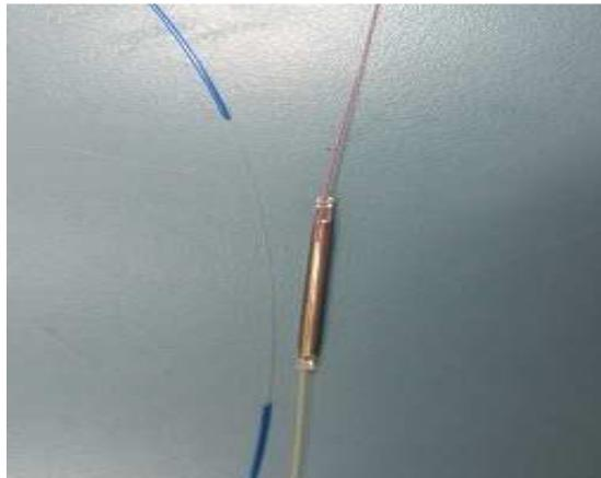
Figura 10 - Diferença entre as fibras após a fusão, fio azul sem a proteção e o fio vermelho com o tubete.
