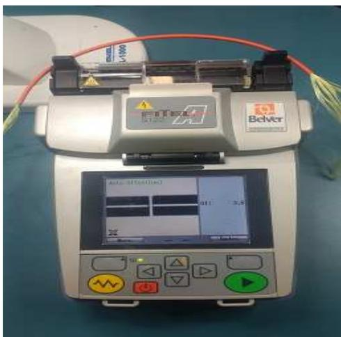
Figura 7 Alinhamentos das fibras ópticas.
