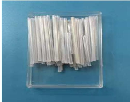
Figura 9 - Tubetes de proteção após a fusão.
