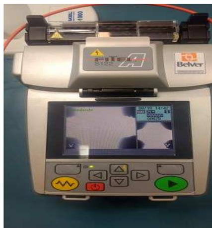
Figura 8 - Fusão da fibra óptica.
