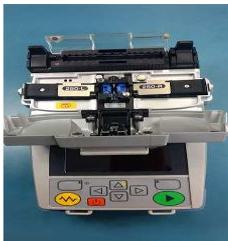
Figura 6 - Eletrodos da máquina de fusão óptica.
